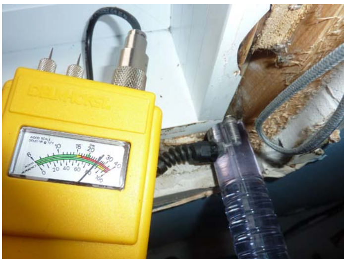
Détecteur d'humidité avec pointes perforantes et rallonge pour détection dans les zones difficiles d'accès.
