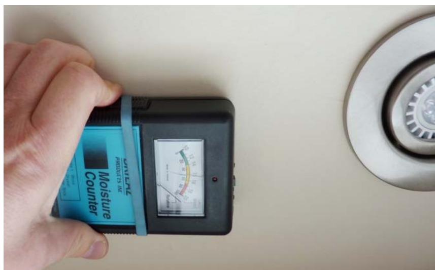
Détecteur d'humidité non dommageable pour les finis. La profondeur de détection est limitée, mais ce genre d'appareil est très efficace et demeure un outil que la plupart des experts en sinistre utilisent couramment.
