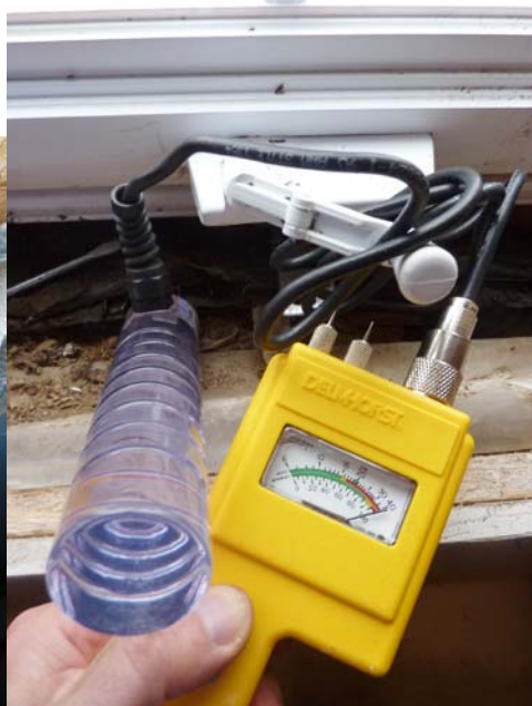
Détecteur d'humidité avec pointes perforantes et rallonge pour détection dans les zones difficiles d'accès.
