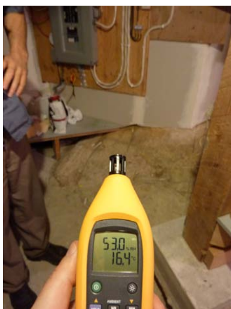
Détecteur d'humidité non dommageable pour les finis. La profondeur de détection est limitée, mais ce genre d'appareil est très efficace et demeure un outil que la plupart des experts en sinistre utilisent couramment.
